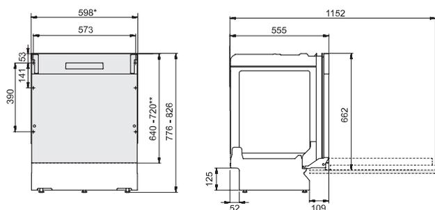
\*如果廚具預留凹槽寬度少於596-598公釐可移除塑膠膠條來調整。 單位:mm
